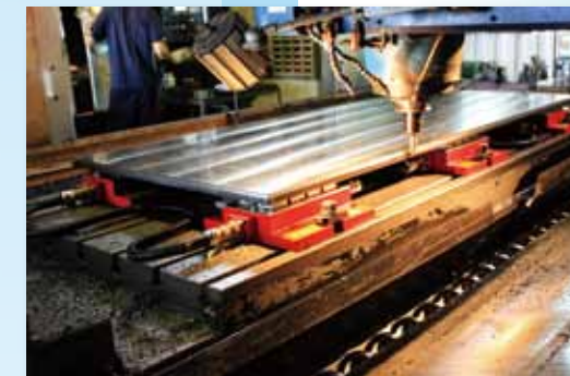
永磁式電控磁盤－連結型 EEPM-C
