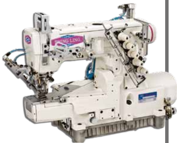
VG-999高速橫筒型三針五線雙面 飾綳縫機
