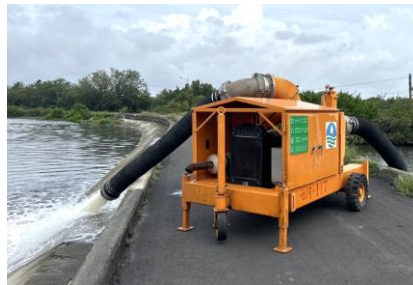
大型移動式抽水機
